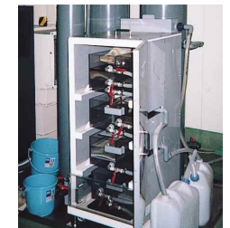
油水分離装置
