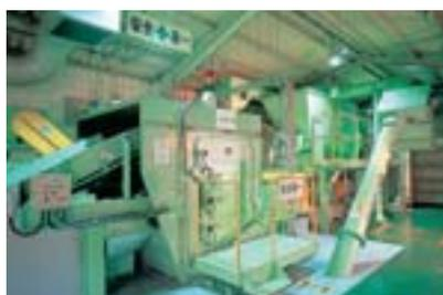
RPF(Refuse Paper and Plastic Fuel)設備:紙くずと廃プラスチックによる固形燃料化装置
