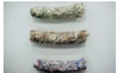
1999年に導入したRPF (Refuse Paper and Plastic Fuel) システムにより、廃プラスチックと紙くずを固形燃料として再資源化(相模原工場)
