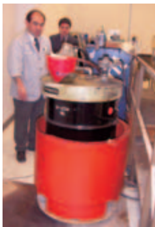
廃インキを移し替える際の漏洩を想定し、専用のポリ容器内にドラム缶を設置(Toppan Interamerica Inc.)
