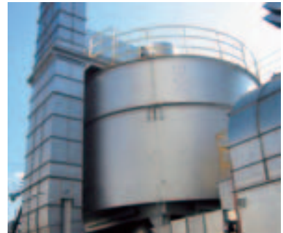
グラビア印刷機からのVOC排ガスを燃焼し無害化処理する装置(相模原工場)
