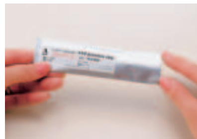
SNPチップにはあらかじめ試薬を入れておき、血液との反応を見る。
