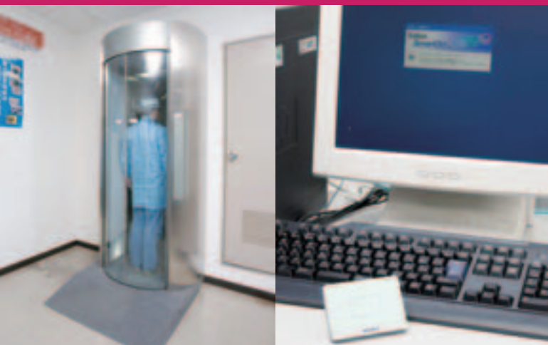
左：本人認証と二重扉により、本人だけが通過できるゲート。 右：社員証（ICカード）の認証により、登録された本人だけが使用できるパソコン。
