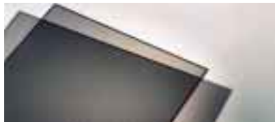
液晶テレビの部材「カラーフィルタ」上に形成するブラックマトリクス材料をクロムから樹脂に変えるとともに、マトリクスの幅を狭め、少ない電力で同じ明るさを実現。
