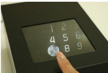
液晶ディスプレイの映像を、特殊な形状のマイクロミラーを介して、何もない空間に実像を表示させ、空中に映像が浮かんでいるように見えるディスプレイです。将来的に空間センサと組み合わせて直接ディスプレイに触ることなく操作可能な次世代 HMI(ヒューマンマシンインタフェース)としての幅広い市場で期待されています。
