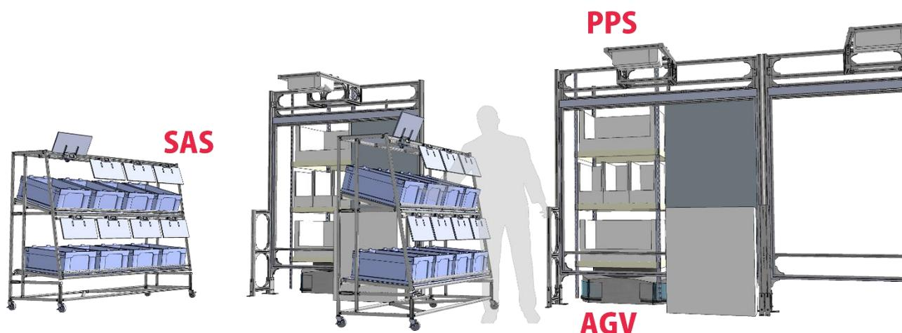
中小規模のアセットライトなピッキング・仕分け工程に導入するシステム・機器のイメージ。
