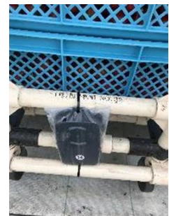
植物工場内で作業時に使用する台車に UWBデバイスを取り付け作業計測
