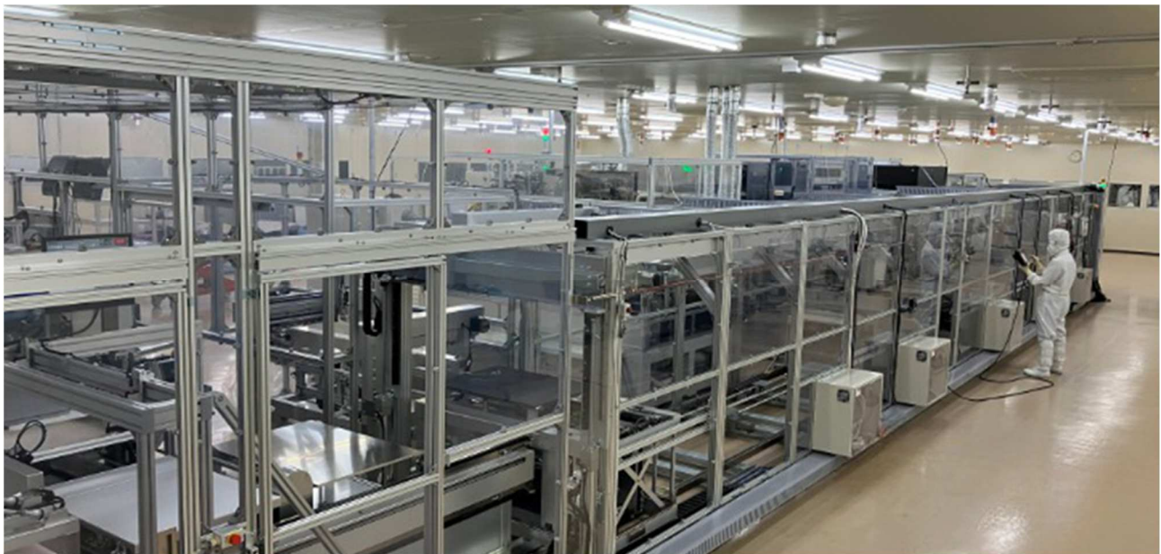
高知工場に導入した CCM/MEA 生産設備
