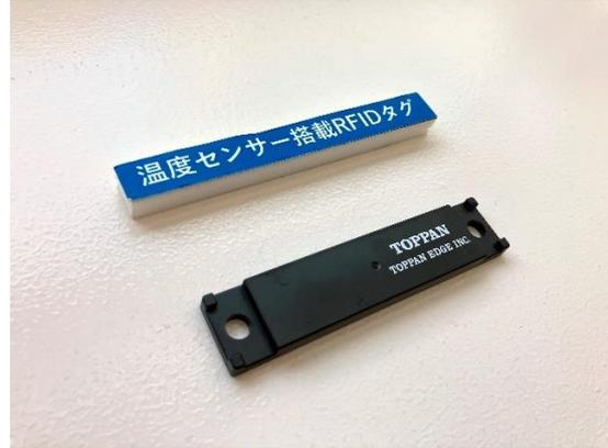
液漏れ検知 RFID タグ(左)、温度センサー搭載 RFID タグ(右)
