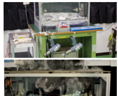
タコ足配線による電気火災の怖さと定格容量の遵守および電気火災の防止策を学習
