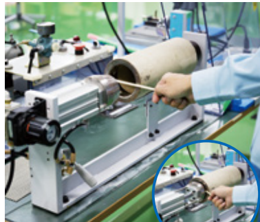
機械のチャッキング部分に割箸を差し込み、挟まれた衝撃を体感
